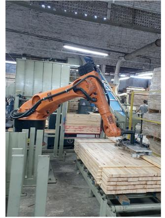
novos robôs, 3 deles vão ser utilizados para automatizar uma célula de laminação de montante e 1 deles vai fazer uma transição, ou seja, vai movimentar porta de uma linha de pintura para outra. O benefício dos robôs é nítido”, segundo Odirlei. Além de melhorar a ergonomia e tirar o serviço manual e repetitivo das mãos das pessoas, o robô consegue gerar economia de material na linha de produção.
